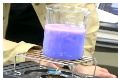
図 6 加温時の水の移動 (示温インク添加)
