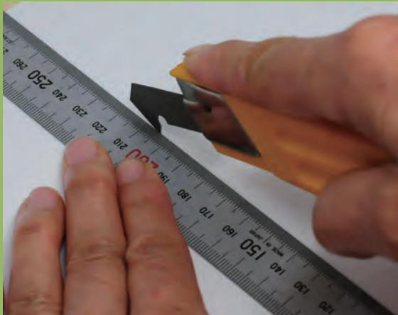
刃先を手前に引きながら、溝を切ります。 目安は厚みの半分
