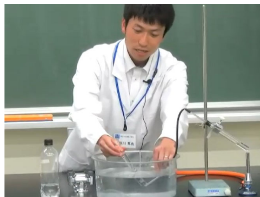
図 2 水上置換による気体の収集
