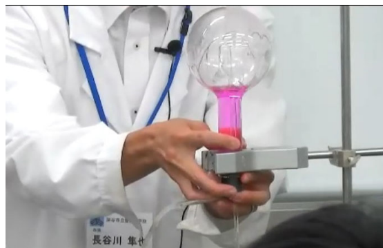
図 3 アンモニアの噴水実験
