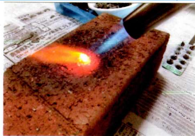
黒曜石のかけらをガストーチで十分に加熱し、発泡させま
