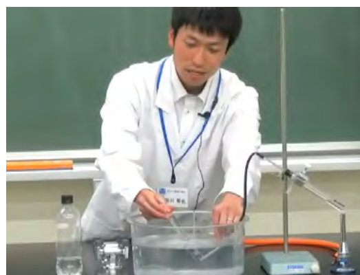
図 2 水上置換による気体の収集
