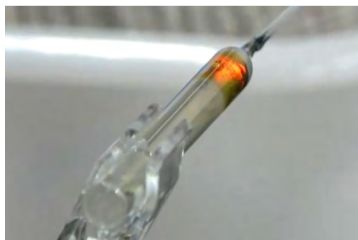
図8 パストゥールピペットを用いた鉄と硫黄の反応
