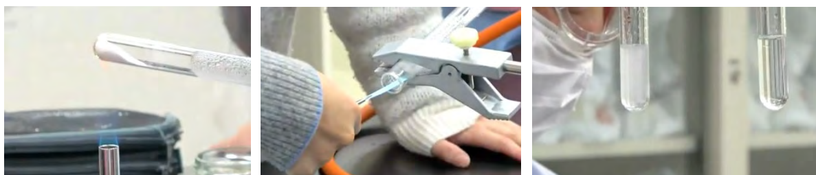
図3 実験により検証（炭酸水素ナトリウムの加熱・塩化コバルト紙や石灰水による物質や気体の確認）
