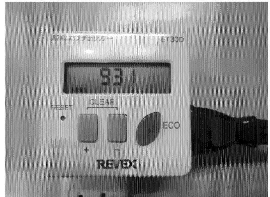
前時の授業では、ドライヤー、扇風機、CDラジカセ、50インチTV、白熱電球、LED電球、電気ポット、DVDプレーヤーの中から班ごとに数種類選択させ、3分間作動させ消費電力を計測した。そして、電気器具に流れている電流と電気抵抗を算出させてみた。また、この授業内での積算使用時間(時間)、積算電気料金(円)、1時間あたりの電気料金(円)、積算使用電力(kWh)、積算CO<sub>2</sub>排出量(kg)も計測した。
